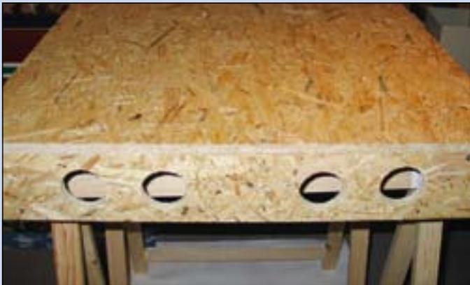
Die Grundkonstruktion besteht aus OSB-Platten, eine Art grobe Spanplatte. Die Platten sind zwar recht schwer, bringen aber Stabilität.
